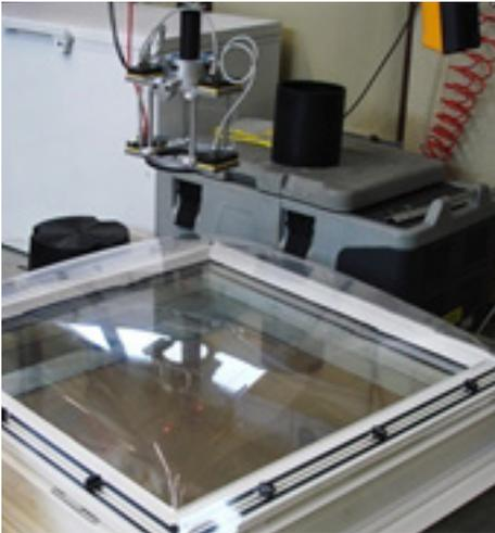
Durch eine geeignete Materialwahl können Hagelschäden an der Gebäudehülle verhindert werden. Deshalb prüfen wir mit einer akkreditierten Hagelbeschussanlage der Empa in Dübendorf Ihre Dach- und Fassadenbauteile auf den Hagelwiderstand. Die Einstufung in eine Hagelwiderstandsklasse ist für das Hagelregister (hagelwiderstandsfähige Bauprodukte) der Vereinigung Kantonalen Feuerversicherungen (VKF) gültig. Wir führen auch Voruntersuchungen und individuelle Testserien zu Forschungszwecken durch.
